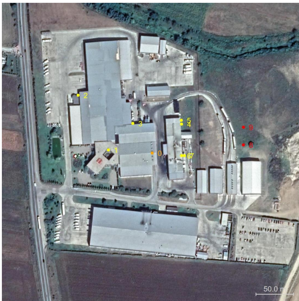
Figura 2 Surse fizice de poluanți identificate pe amplasamentul societății SC TRANSAVIA SA - Abator Oiejdea. 0 - originea sistemului de coordonate local utilizat în modelare. 1 - Grup termic de 2 \times 0.125 MW (la sediul administrativ); 2 - Centrală murală de 0.03 MW (la biroul facturare); 3 - Centrală murală de 0.03 MW (la atelier); 4 - Cazan de abur de 2.6 MW; 5 - Cazan de abur de 3.9 MW; 6 - Instalație spălare gaze făină proteică; 7 - Instalație spălare gaze făină proteică; 8 - Instalație spălare gaze făină proteică (nouă); 9 - Cazan de abur de 4.42 MW (nou). Sursele existente (1-7) sunt figurate cu galben, iar surse noi (8-9) sunt figurate cu roșu.
