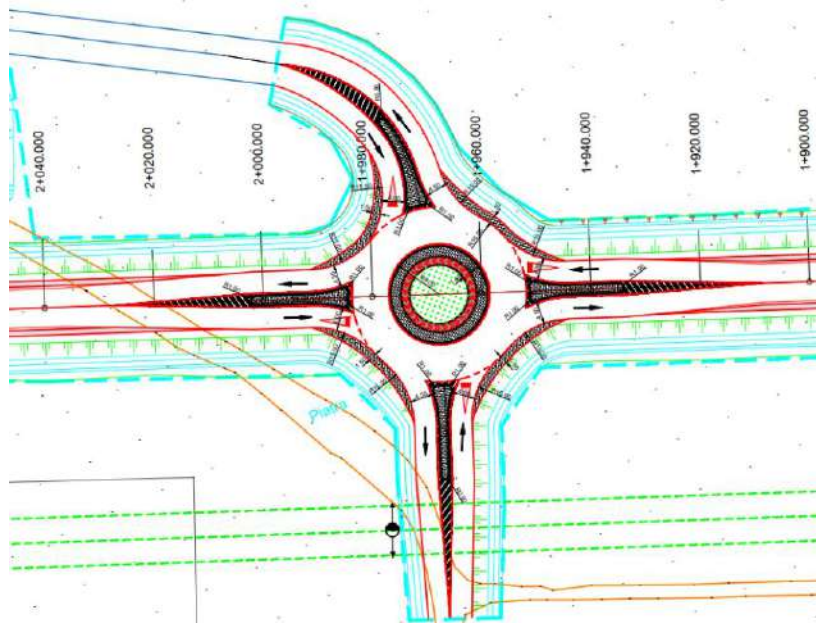
Figura nr. 4 – Amenajare girație strada Turnatoriei, zona Barabant, langa Saturn SA
