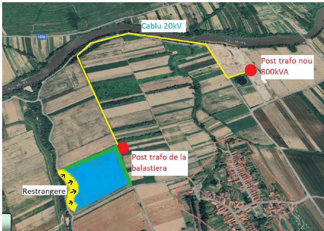
Figura nr. 5.Mod amplasare posturi trafo
