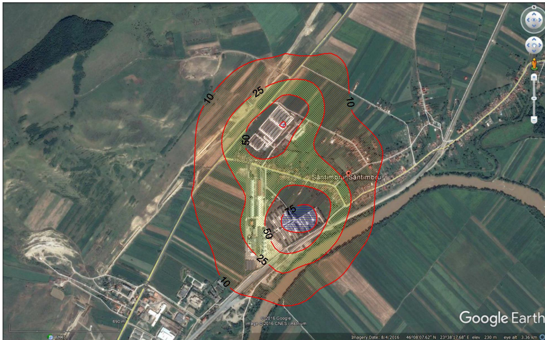
Fig. nr.2. Concentratii maxime de amoniac in aer – timp de mediere 24 ore (fermele 3 si 4 TRANSAVIA)
