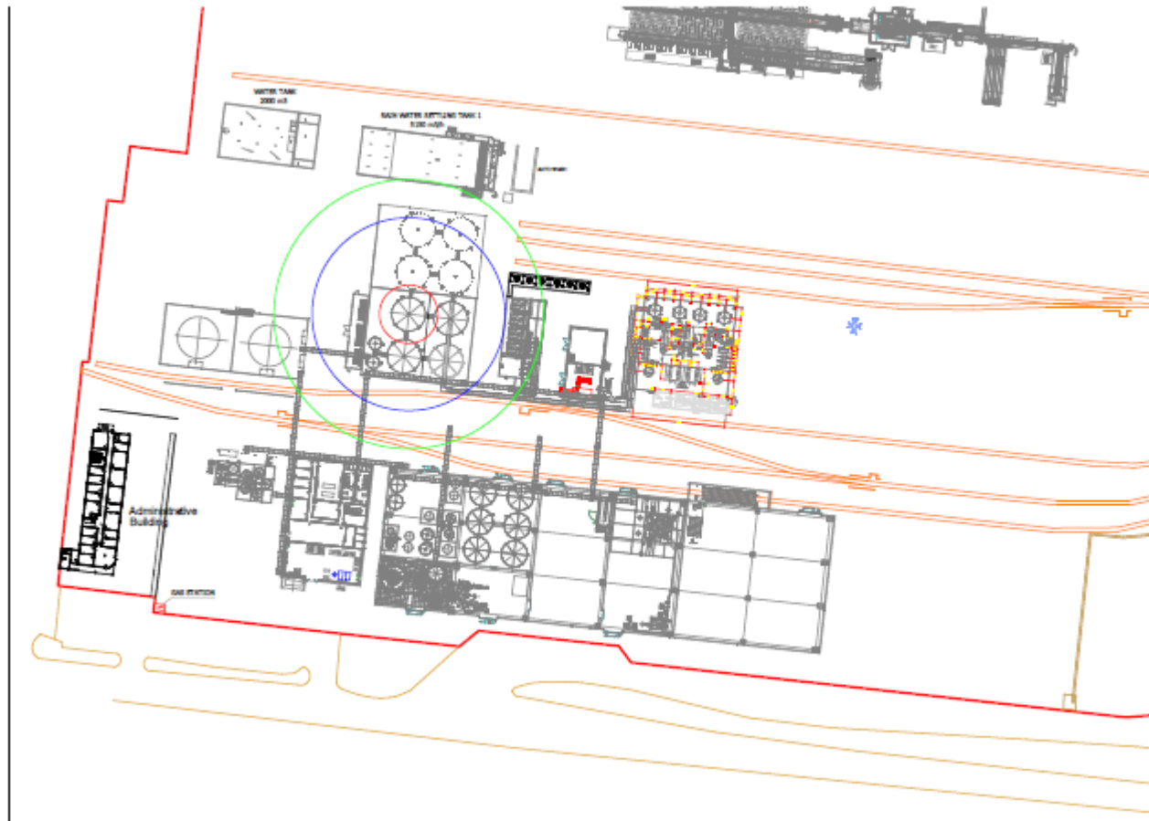
Figura nr. 39 Scenariul 4.b.2. - Avarie la un rezervor de formaldehida T = 37,7^{\circ}\text{C} ; U = 41\% . Conditii de raspandire medii
