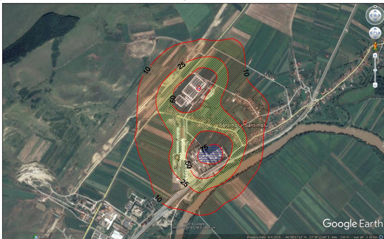
Figura 4: Concentratii maxime de amoniac in aer – timp de mediere 24 ore (fermele 3 si 4 Santimbru)
